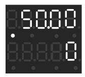
第一行显示设定频率,第二行显示 0;按左移键切换第一行显示的参数,按右移键切换第二行显示的参数。(输出频率、设定频率、输出电流、输出电压、直流母线电压)。按 ESC 进入一级菜单。
