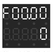
第一行显示功能码,第二行显示功能码对应参数。光标在第一行闪烁,表示当前在操作第一行的数据;光标在第二行闪烁,表示当前在操作第二行的数据。可修改参数则光标会闪烁,不可修改参数光标不会闪烁。在 U 模式和 C 模式修改功能码时光标不可左右移。
