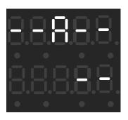
按上下键进行模式的切换。有三种模式可供选择,全菜单模式(--A--),用于显示所有功能码;用户自定义模式(--U--),用于只显示用户通过 F11 组选择的功能码;非出厂值模式(--C--),用于只显示与出厂值不同的功能码。按 ESC 跳转回零级菜单,按 ENTEER 进入对应的二级菜单界面。
